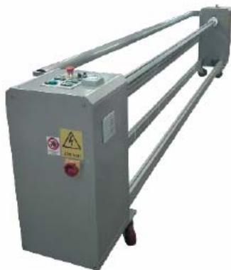
Mit diesem Aufwickelsystem können Sie einzelne oder mehrere lange Bahnen nach dem Schneiden mit einer Fotoba Schneidemaschine gleichzeitig wieder aufwickeln.
