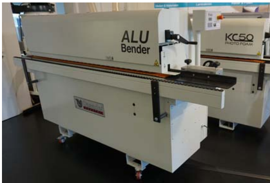
Vorführmaschine Casadei AluBender automatische Fräs- und Biegemaschine mit Kettentransport für Hartfaser-substrate und Aluminium Verbundplatten, HPL Resopal und Alu Wabenplatten, Bj. 2016 Technische Daten: (Details bitte anfragen) Neupreis: € 23.830,- Verkaufspreis: €17.990,-
